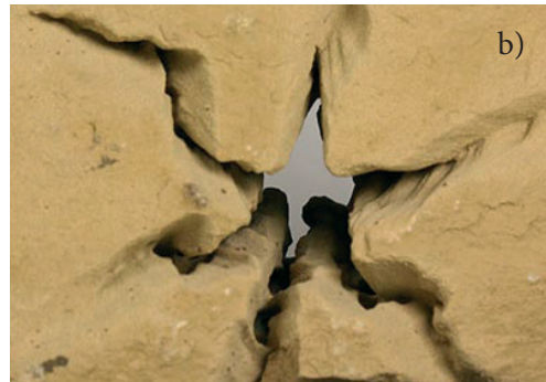
4 pav. a) veikiančio purkštuko pavyzdys (centrinė skylutė ir keturios atbulinės atšakos); b) skirtingo skersmens hidraulinio spindulinio gręžimo purškimo skylutės smiltainyje
